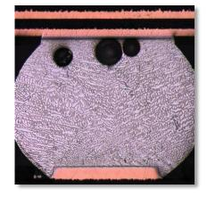
Nuestros servicios de bisección transversal incluyen un reporte detallado del analisis de las muestras, donde se especifican los problemas identificados y las no conformidades de los ensambles. Los reportes incluyen imágenes con detalles de las dimensiones relevantes como unión intermetálica o vacíos en la soldadura u otros defectos detectados en el ensamble.
